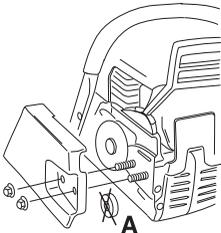
Monte a lâmina nos seus parafusos. Coloque a lâmina na sua posição mais atrás. Ponha a corrente sobre o pinhão e a ranhura da lâmina. Comece pela parte superior da lâmina.
