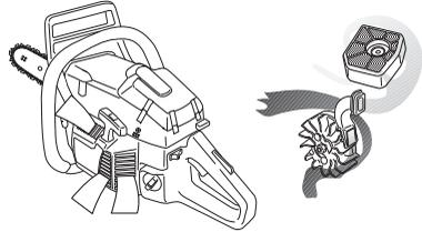
**IMPORTANTE!** Para conservar a função de purificação centrífuga, é necessário prestar assistência e manutenção contínuas. Limpe a entrada de ar do dispositivo de arranque, asas de ventoinha da cambota, compartimento em torno da cambota, tubo de admissão e compartimento do carburador.
