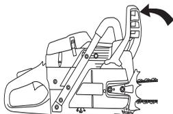
Desensrosque las tuercas de la espada y saque la cubierta del embrague (el freno de cadena). Saque la protección de transporte (A).
