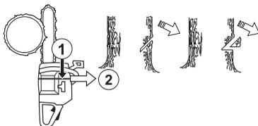
A profundidade do corte direccional deve ser de 1/4 do diâmetro do tronco e o ângulo entre o corte superior e o inferior, no mínimo de 45°.
