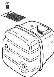
O silenciador é configurado para abafar o nível de ruído e para conduzir os gases de escape para longe do utilizador. Os gases de escape são quentes e podem conter faíscas que podem causar incêndios, se os gases forem dirigidos contra um material seco e inflamável.
