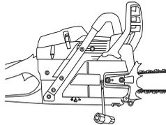
A corrente está correctamente esticada quando não mais estiver frouxa na parte inferior da lâmina e ainda possa ser girada facilmente com a mão. Aperte bem as porcas da lâmina com a chave universal ao mesmo tempo que segura a extremidade da lâmina.
