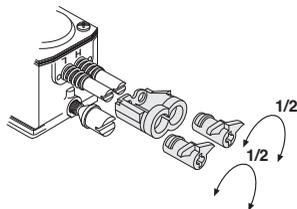
Si el carburador de su motosierra tiene limitadores de movimiento, hay que ajustarlo siguiendo las instrucciones bajo el titular 'Carburador con limitadores de movimiento'.
