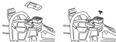
Uma limpeza mais completa obtém-se ao lavar o filtro com água e sabão.
