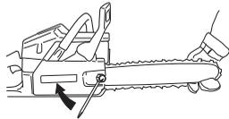
Numa corrente nova, a tensão deverá ser controlada constantemente até concluir a rodagem. Verifique a tensão da corrente regularmente. Uma corrente correcta significa boa capacidade de corte e longa vida útil.
