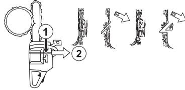
La profundidad del corte de indicación debe ser igual a 1/4 del diámetro del tronco, y el ángulo entre los cortes superior e inferior debe ser de 45° como mínimo.
