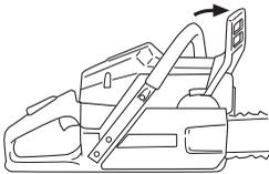
**Arranque:** O travão da corrente deve estar activado no arranque da moto-serra. Active o travão levando a protecção contra o retrocesso para a frente.
