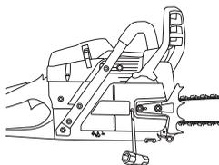
La cadena está correctamente tensada cuando no cuelga en la parte inferior de la espada y puede girarse fácilmente con la mano. Apriete las tuercas de la espada con la llave combinada, sujetando al mismo tiempo la punta de la espada.
