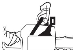
Acelere ao máximo e active o travão de corrente, virando o pulso esquerdo contra a protecção anti-retrocesso. Não
