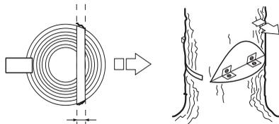
Se pierde completamente el control de la dirección de derribo del árbol si la faja de desgaje es demasiado pequeña o se atraviesa al cortar, o si los cortes de indicación y derribo están mal situados.
