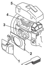
Limpie el sistema refrigerante con un cepillo una vez por semana (en condiciones difíciles, con mayor frecuencia). Un sistema refrigerante sucio u obturado produce sobrecalentamiento de la máquina, con las consiguientes averías del cilindro y el pistón.
