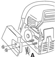
Monte la espada en los pernos. Sitúela en la posición posterior extrema. Monte la cadena en el piñón de arrastre y la guía de la espada. Empiece con la parte superior de la cadena.
