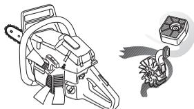
**¡IMPORTANTE!** Para que la depuración centrífuga funcione satisfactoriamente, debe efectuarse un mantenimiento constante del sistema. Limpie la toma de aire del mecanismo de arranque, las palas de ventilador del volante, el espacio alrededor del volante, el tubo de admisión y el compartimiento del carburador.
