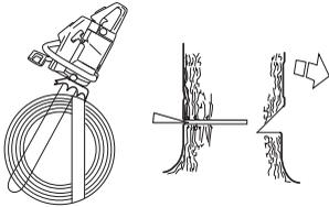
O corte de abate deverá terminar paralelamente à linha de corte direccional de modo que a distância entre ambos seja no mínimo de 1/10 do diâmetro do tronco. A parte não serrada no tronco é designada de linha de ruptura.
