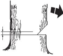
Coloque o apoio para casca (se estiver montado) atrás da linha de ruptura. Serre com aceleração total e deixe a corrente/lâmina penetrar devagar na árvore. Observe se a árvore se move no sentido contrário ao da direcção de queda pretendida. Introduza uma cunha de abate ou barra extractora logo que a profundidade de corte o permita.
