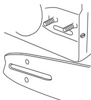
Tense la cadena enroscando en el sentido de las agujas del reloj el tornillo de tensado con la llave combinada. La cadena debe tensarse hasta que deje de colgar en la parte inferior de la espada.
