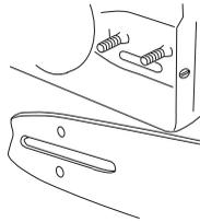
Estique a corrente, apertando com o auxílio da chave universal o parafuso esticador da corrente, no sentido horário. Estique a corrente até que esta deixe de estar frouxa na parte inferior da lâmina.
