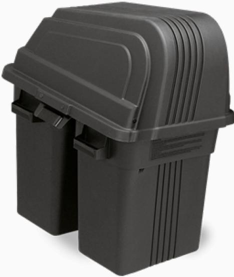
Colector de gran capacidad (210 litros) con dos compartimentos. Se adapta a la plataforma de corte de 97 cm
